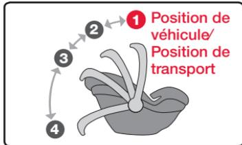
Pour régler, appuyez et maintenez les deux leviers d'ajustement de la poignée et tourner la poignée à la position choisie.
