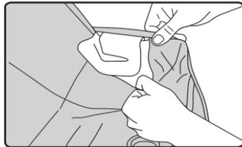
7. Tirez la housse d'autour le bouton d'ajustement du harnais et soulevez la housse du siège loin de la coque du siège.
