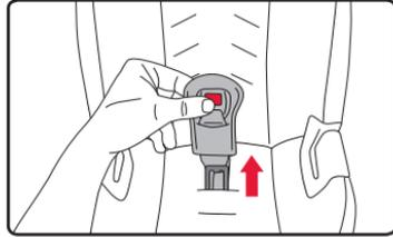
5. Tirez l'onglet pour un retrait facile de housse à desserrez la housse du siège.
