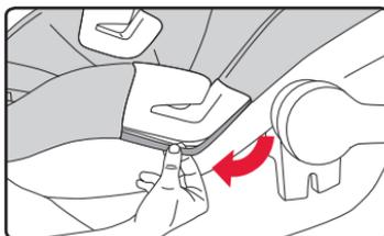
5. Assurez que les sangles ne sont pas entortillées et nfilez à travers les coussinets confort, le coussin de tête, et les fentes appropriées dans la housse et la coque.
