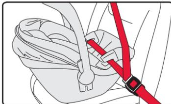
5. Tout en maintenant fermement la base sur le siège du véhicule, retirez tout le mou d'abord de la section sous-abdominale, puis de la section baudrier de la ceinture du véhicule.
