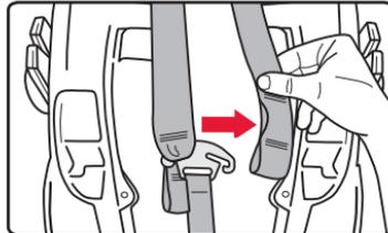
3. De l'avant du siège, passez la sangle de harnais à travers la housse et l'appuie-tête.
