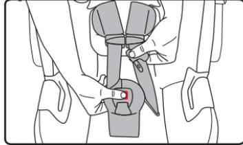
2. Repérez l'arrêteur de la boucle de ceinture au bas du siège d'auto pour bébé et tirez loin du siège pour desserrer.
