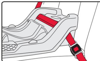
3. Tout en maintenant fermement la base sur le siège du véhicule, tirez d'abord sur la section abdominal puis sur la section baudrier de la ceinture de sécurité du véhicule pour en enlever tout le mou.
