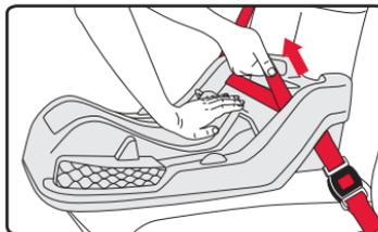
4. Maintenez le ceinture du véhicule baudrier bien tendu et faites glisser fermement sous le verrou sur le côté de la base opposée la boucle.
