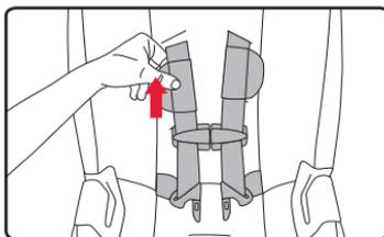
6. De l'arrière du siège, glisser les sangles du harnais complètement sur la chape du harnais. Assurez que la sangle d'ajustement du harnais n'est pas entortillée.
