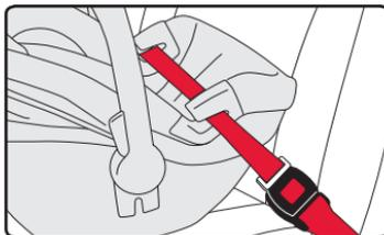
5. Tout en maintenant fermement le siège d'auto pour bébé sur le siège du véhicule, retirez tout le mou de la ceinture de sécurité du véhicule.
