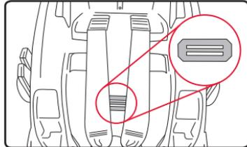
3. Tournez l'arrêteur de la boucle de façon que le côté court puisse passer dans la fente de la coque et de la housse du siège d'auto pour bébé.
