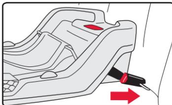
4. Tout en appuyant sur le centre de la base dans le siège du véhicule, tirez sur les sangles d'attaches inférieures pour serrer.
