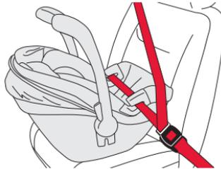
Installation du siège pour bébé sans la base avec la ceinture baudrier/sous-abdominale
