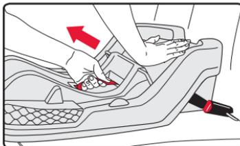
5. Acheminez l'excédent de sangle dans la base et s'assurer que les sangles d'attaches inférieures sont au même niveau avec la base.
