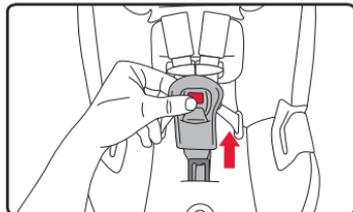
5. Passez l'arrêteur dans la fente appropriée de la housse et de la coque afin de positionner la boucle.
