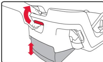
2. Déplacez la base vers le haut ou vers le bas jusqu'à ce que le repère rouge est visible entre les deux lignes sur les indicateurs d'angle d'inclinaison tandis que sur le siège du véhicule.
