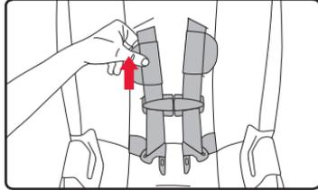
2. Desserrez le harnais en enfonçant le levier du dispositif d'ajustement du harnais tout en tirant vers l'avant les deux sangles du harnais.
