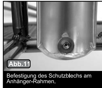
Die Schutzblech-Strebe wird mit den Schellen so, wie gezeigt, am Schutzblech befestigt.
