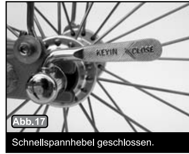
Schnellspannhebel im 90-Grad-Winkel zur Stirnfläche des Ausfallendes.
