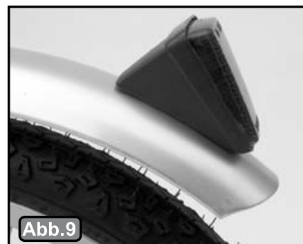
Richtige Ausrichtung des Reflektors am Schutzblech.
