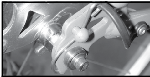
Abb. 6 Richtig installiertes Deichselausfallende
