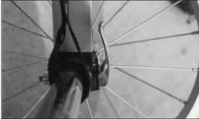
Fig. 13 - Quick release closed and parallel to swing arm tube. Serrage rapide fermé et parallèle au tube du bras oscillant. Schnellspanner in geschlossener Position und parallel zum Schwingarm.
