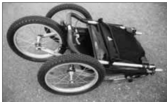
Fig. 20 - Stroller in fully folded position. Stroller dans la position entièrement repliée. Jogger in zusammengefalteter Position.
