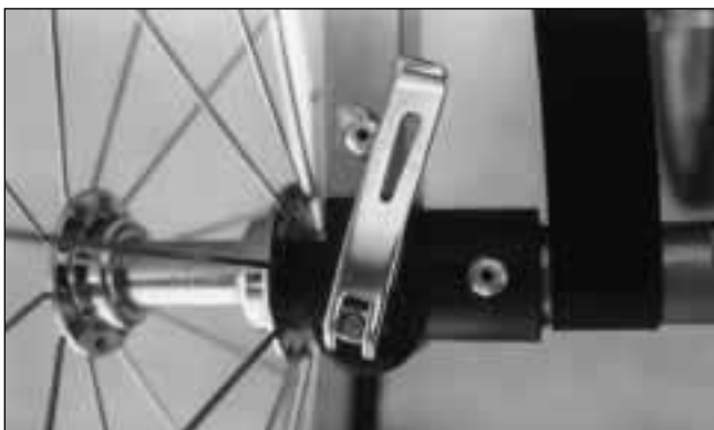
Fig. 11 - Rear wheel installed with snap ring contacting dropout. Roue arrière installée (contact patte de roue/circlip). Korrekt eingesetztes Hinterrad. Schnappring ist eingerastet.
