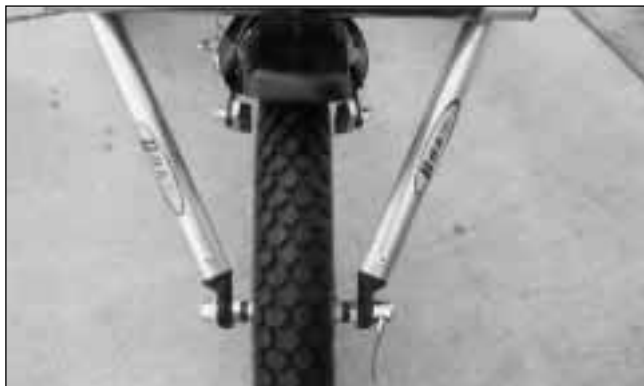
Fig. 7 - Front wheel dropout shown with wheel in correct position. Patte de roue avant montée la roue. Korrekt eingesetztes Vorderrad.
