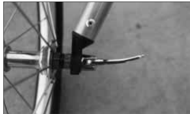
Fig. 8 - Quick release perpendicular to the dropout. Serrage rapide perpendiculaire à la patte. Schnellspanner senkrecht zur Radachse.
