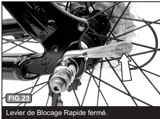
Levier de Blocage Rapide perpendiculaire à l'avant de la patte.
