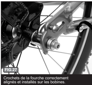
Position correcte pour attache de la remorque au vélo.
