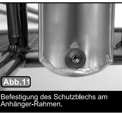
Befestigung des Schutzblechs am Anhänger-Rahmen.
