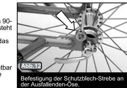
Befestigung der Schutzblech-Strebe an der Ausfallenden-Öse.
