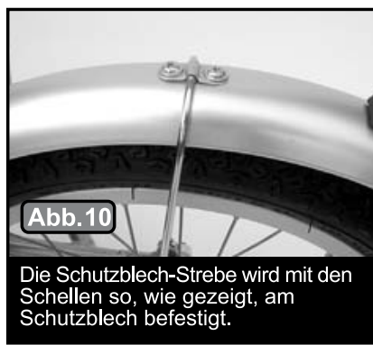
Die Schutzblech-Strebe wird mit den Schellen so, wie gezeigt, am Schutzblech befestigt.
