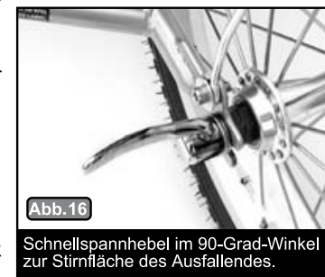
Schnellspannhebel im 90-Grad-Winkel zur Stirnfläche des Ausfallendes.
