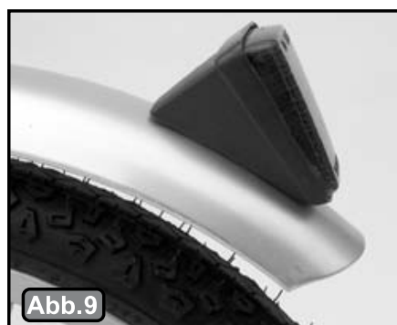
Richtige Ausrichtung des Reflektors am Schutzblech.
